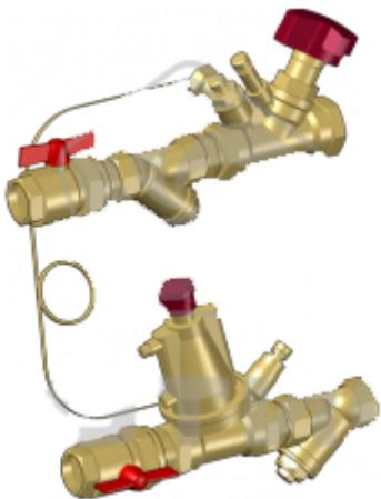
Модуль ввода МВТ СОТИС-Unit предназначен для подключения узла учета тепловой энергии УУТЭМ-Э на этаже к подающему и обратному центральным распределительным стоякам системы отопления здания и фильтрации поступающего к потребителям теплоносителя.
